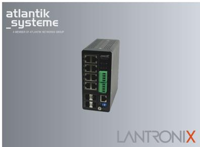
Der SISPM1040-384-LRT-C von Lantronix ist ein managed PoE+ Switch, der sich für den Anschluss und die Stromversorgung von Geräten in anspruchsvollen Umgebungen eignet. Der Switch kann bis zu 30 Watt pro Port an allen (8) Ports gleichzeitig liefern und enthält die eingebettete Device Management System-Software, die die erforderlichen fortschrittlichen Tools für die vollständige Verwaltung aller IP-adressierbaren Geräte bereitstellt.
